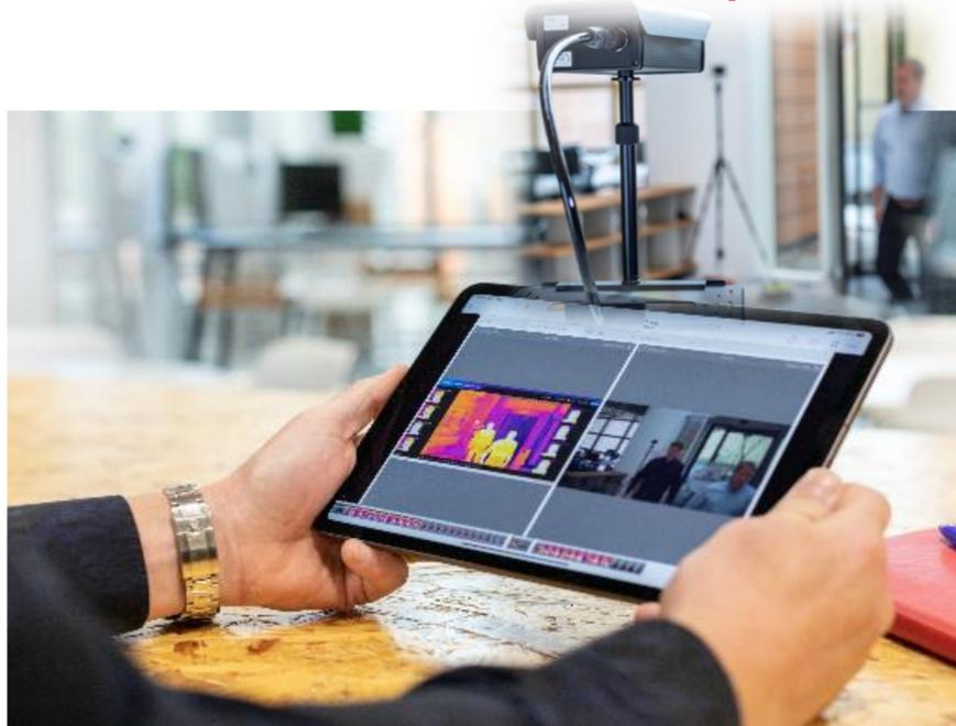
Eine Kamera **agiert als Sensor** zur Erfassung erhöhter Körpertemperatur (**Sunrise Heat Detection Lösung**)
